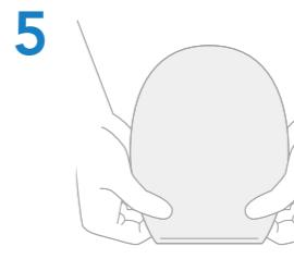
排出口端の白いプレートを4回折り上げます。重なったマジックテープ部がチチチと音がするまでしっかりと押して、排出口を閉じます。これで手順は完了です。
