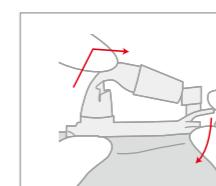
排出口を上向きにしてキャップを外し、キャップをつまみながら、下向きにして排出します。
